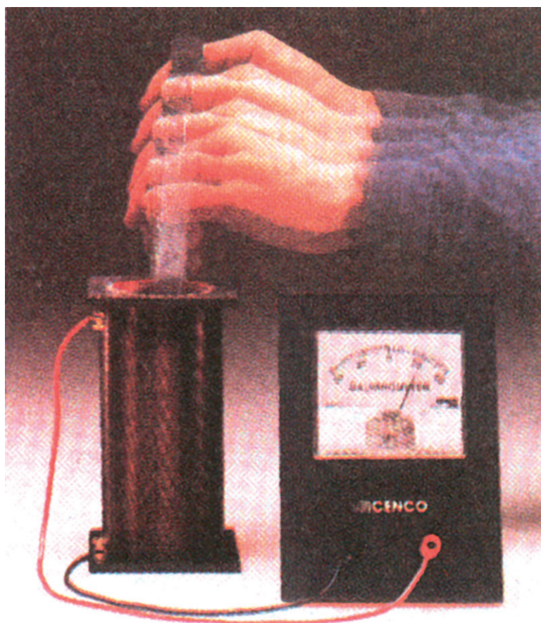
Εικ. 5.3 Πειραματική επίδειξη δημιουργίας ρεύματος σε κλειστό κύκλωμα εξαιτίας της κίνησης ενός μαγνήτη.
