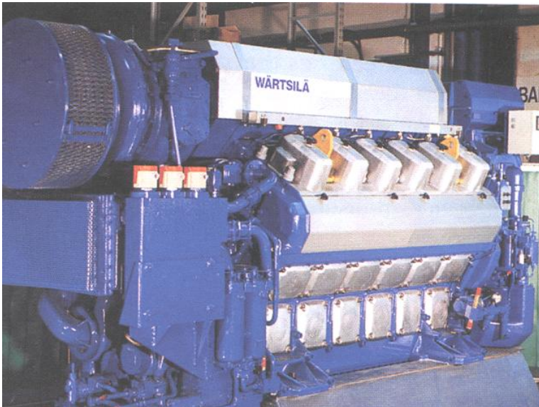
Εικ. 4.8 Φινλανδικός κινητήρας Diesel Wartsila 12 κύλινδροι σε διάταξη V.
