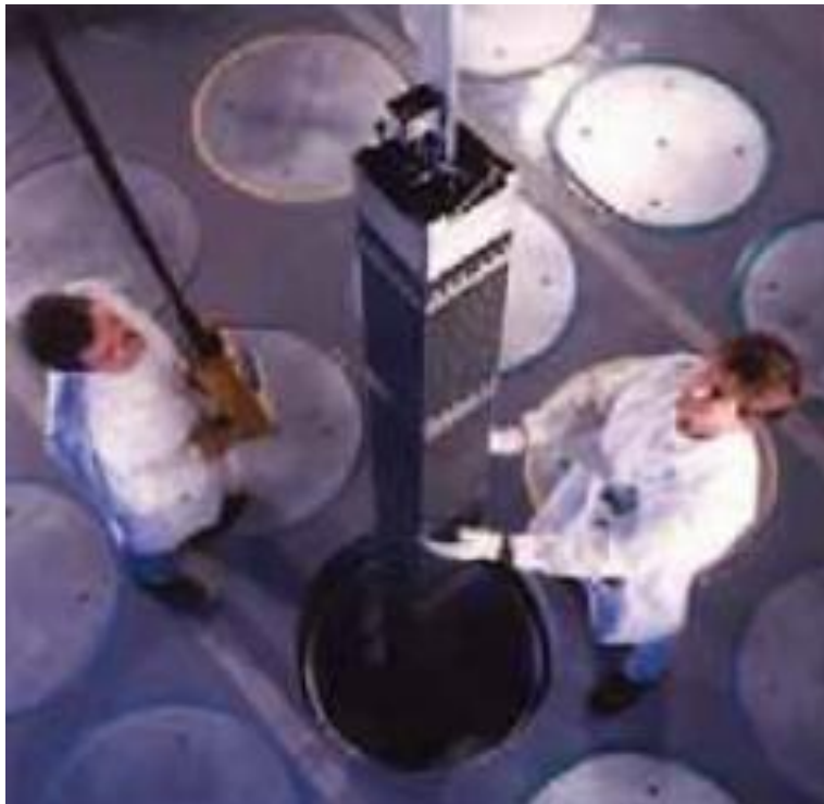
Εικόνα 11.7 Ράβδοι πυρηνικού καυσίμου τη στιγμή που τις κατεβά- ζουν στην
