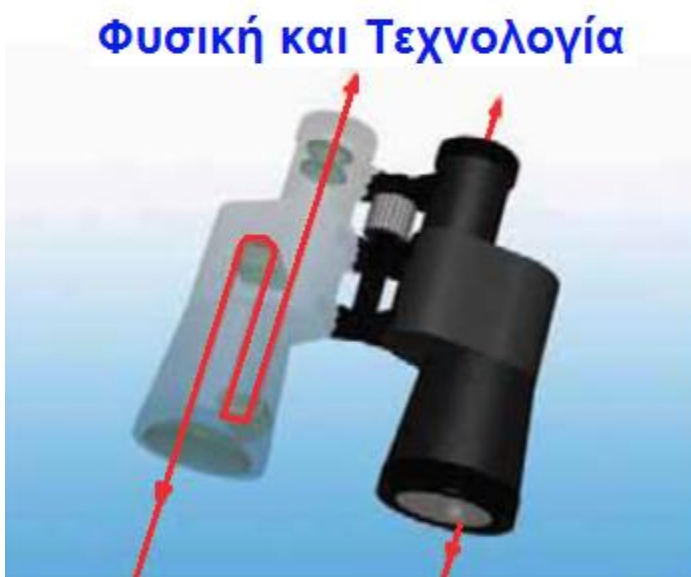
Εικόνα 8.16. Ολική ανάκλαση και κιάλια. Οι περισσότερες διόπτρες (κιάλια) περιέχουν δύο πρίσματα κατάλληλα τοποθετημένα, όπως στην περίπτωση (γ) της εικόνας 8.15 τα οποία προκαλούν μετατόπιση της φωτεινής δέ-
