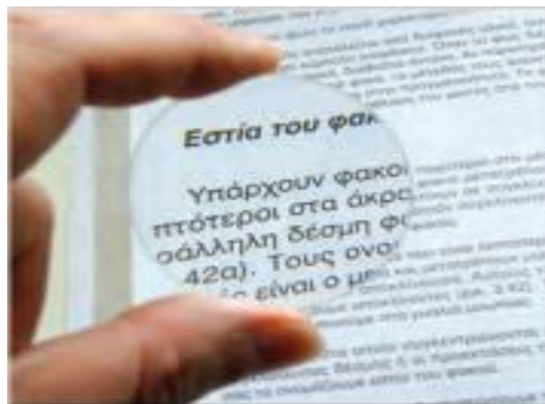
Εικόνα 9.10 Ο συγκλίνων φακός χρησιμοποιείται για τη μεγέθυνση αντικειμένων, όπως τα γράμματα της εικόνας.
