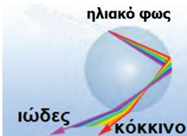
Εικόνα 8.24 Η σταγόνα του νερού συμπεριφέρεται όπως ένα πρίσμα και προκαλεί ανάλυση του φωτός.
