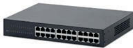
Εικόνα 2.5 Ένας τυπικός μεταγωγέας (switch) με 24 θύρες. Είναι προφανές λόγω του πλήθους των θυρών του ότι μπορεί να δώσει συνδεσιμότητα σε 24 υπολογιστές-συσκευές
