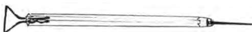
20 Προσαρμογή καρφιού και λυγισμένου τσιμπιδιού σε ένα άδειο στέλεχος από στυλό που έχει θερμανθεί
