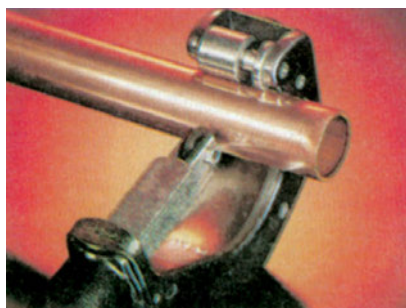
Εικόνα 6.2 Εργαλείο κοπής σωλήνων (σωληνοκόπτης). Στην εικόνα δεξιά, σωληνοκόπτης σε χρήση
