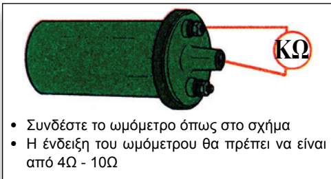
Σχήμα 9.31: Έλεγχος δευτερεύοντος πηνίου πολλαπλασιαστή.
