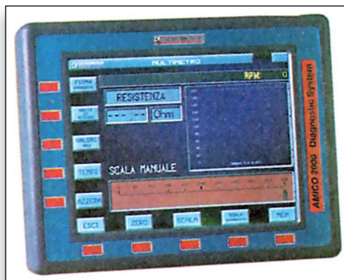
Σχήμα 8.2: Ειδική κονσόλα ελέγχου σε σύστημα αυτοδιάγνωσης κατασκευαστή αυτοκινήτων. Με τη βοήθεια αυτού του σαρωτή είναι δυνατή η επικοινωνία με το μικροϋπολογιστή του αυτοκινήτου.
