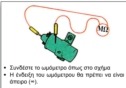
Σχήμα 9.32: Έλεγχος βραχυκυκλώματος πολλαπλασιαστή.
