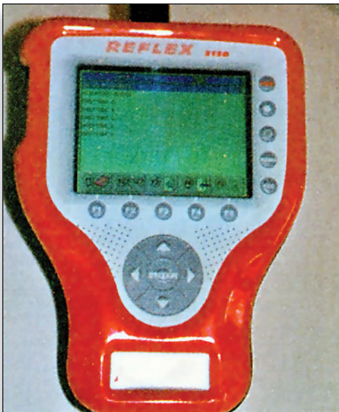
Σχήμα 8.4: Κονσόλα αυτοδιάγνωσης για τους ρύπους του Ευρωπαϊκού προτύπου EOBD.
