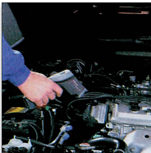
Σχήμα 2.19: Μέτρηση της θερμοκρασίας με θερμόμετρο υπέρυθρων ακτίνων.
