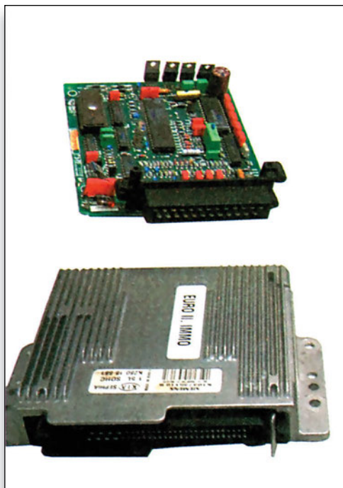
Σχήμα 5.10: Εξωτερική - εσωτερική εμφάνιση κεντρικής μονάδας ελέγχου αυτοκινήτου.
