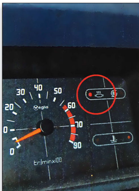
Σχήμα 8.5: Προειδοποιητική λυχνία για καταγραφή βλάβης (CHECK ENGINE).
