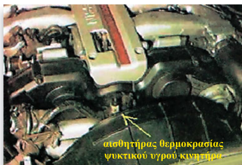
Σχήμα 6.34: Αισθητήρας θερμοκρασίας ψυκτικού υγρού κινητήρα. Η θέση του ποικίλλει ανάλογα με τη σχεδίαση, που κάνει ο κάθε κατασκευαστής.
