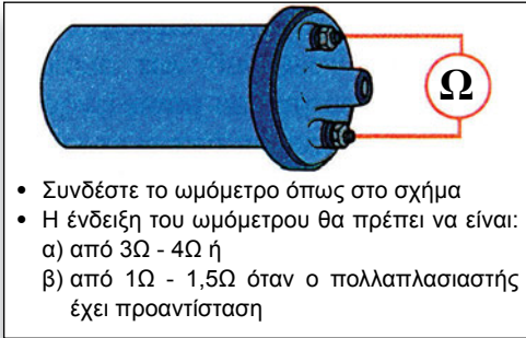
Σχήμα 9.30: Έλεγχος πρωτεύοντος πηνίου πολλαπλασιαστή.
