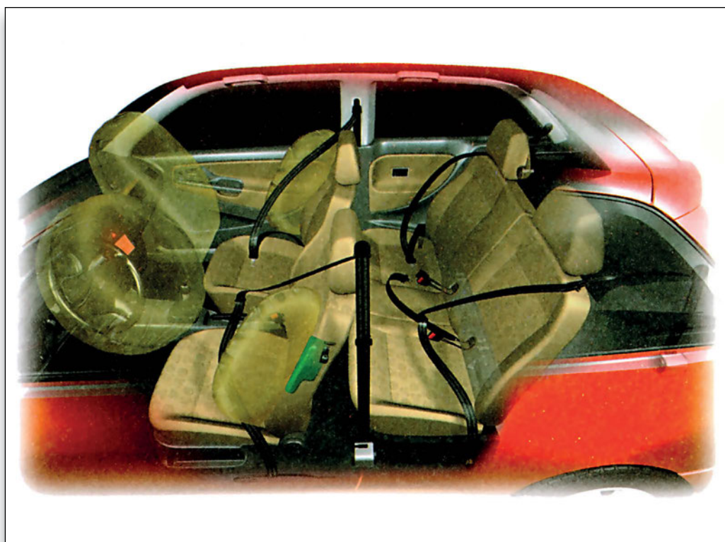
Σχήμα 10.22: Σύστημα πλευρικών αερόσακων και συγκράτησης των επιβατών με ζώνες που έχουν προεντατήρα.
