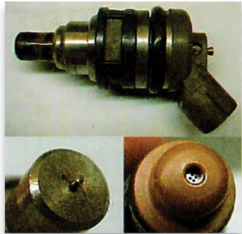
Σχήμα 7.11: Ηλεκτρομαγνητική βαλβίδα ψεκασμού καυσίμου (μπεκ). Η διαμόρφωση του καυσίμου σε μορφή ατμοποιημένου νέφους εξαρτάται όχι μόνο από τη μορφή και το σχήμα του στομίου της βαλβίδας αλλά και από τη συχνότητα ανοιγοκλεισίματος της βαλβίδας, δηλαδή από τη συχνότητα και τη διάρκεια των παλμών τάσης για το άνοιγμα της βαλβίδας.
