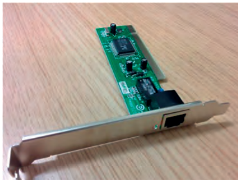
Εικόνα 147: Κάρτα δικτύου ethernet PCI
