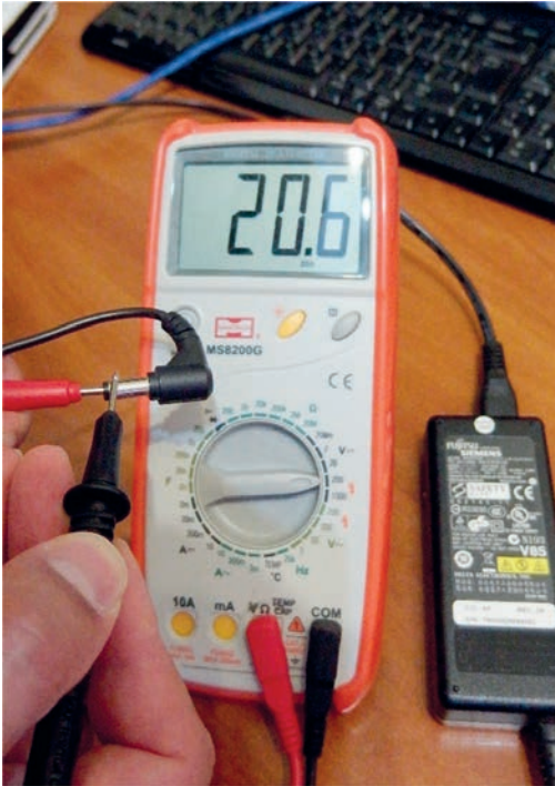
Εικόνα 196. Μέτρηση τροφοδοτικού με πολύμετρο
