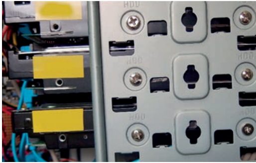
Εικόνα 31.Στήριξη μονάδων δίσκων στο πλαίσιο της θήκης
