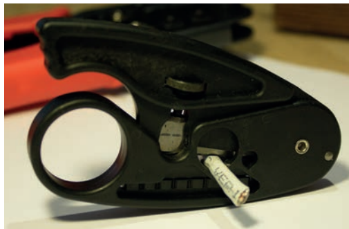
Εικόνα 5: Απογυμνωτής εξωτερικής μόνωσης καλωδίων UTP
