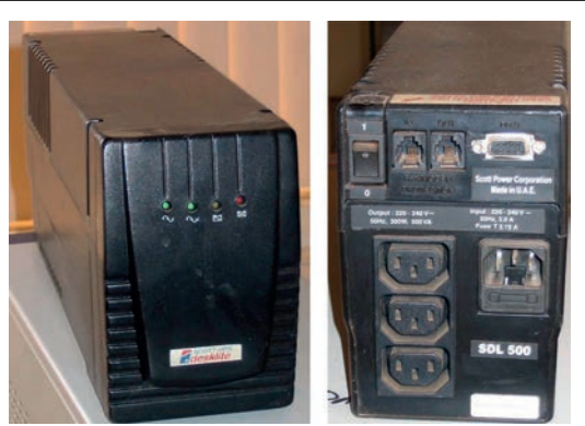
Εικόνα 249 Όψεις μονάδας UPS
