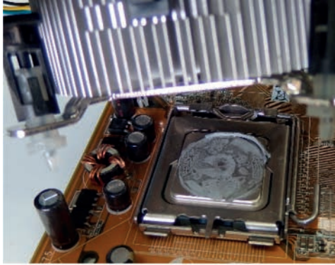
Εικόνα 63. Αφαίρεση συστήματος ψύξης
