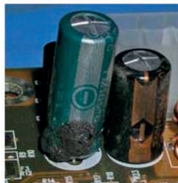
Εικόνα 263: Κατεστραμμένος πυκνωτής σε μητρική πλακέτα
