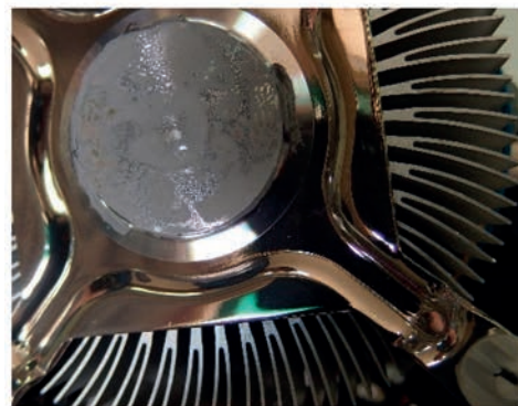
Εικόνα 65. Κατάλοιπα θερμοαγωγίμης κόλλας
