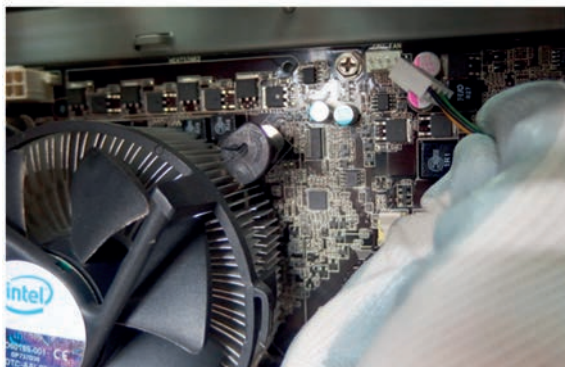
Εικόνα 57. Τοποθέτηση συνδέσμου ανεμιστήρα ΚΜΕ 4 καλωδίων (PWM), στην υποδοχή ανεμιστήρας ΚΜΕ (CPU_FAN) εργοστασιακού συστήματος ψύξης
