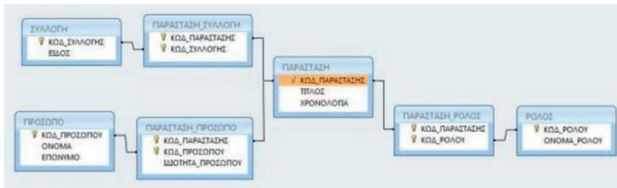
Εικόνα 7.2 Ψηφιοποιημένο αρχείο Εθνικού Θεάτρου: Απλοποιημένο σχήμα ΒΔ
