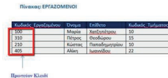
Σχήμα 3.5.2: Το πρωτεύον κλειδί του πίνακα ΕΡΓΑΖΟΜΕΝΟΙ είναι η στήλη Κωδικός_Εργαζομένου
