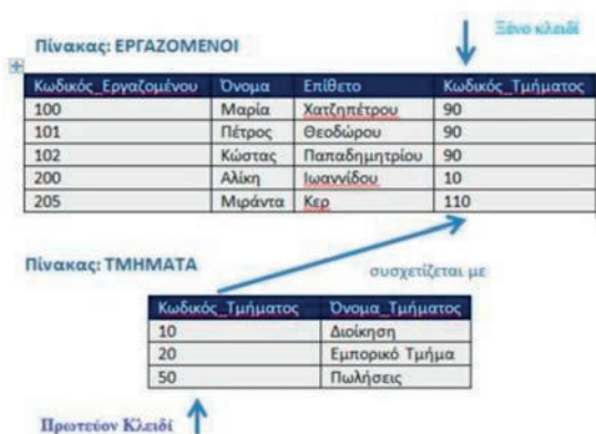
Σχήμα 3.5.4: Το ξένο κλειδί ενός πίνακα «συνδέεται» με το πρωτεύον κλειδί ενός άλλου πίνακα
