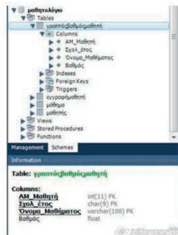
Εικόνα 9. Επισκόπηση του πίνακα ΓραπτόςΒαθμόςΜαθητή στο σχήμα Μαθητολόγιο
