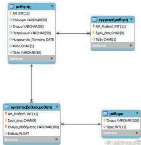
Εικόνα 10. Το διάγραμμα πινάκων και συσχετίσεων για τους πίνακες του μαθητολογίου
