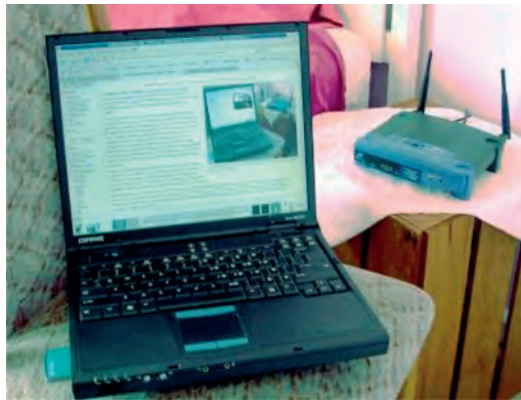
Εικ. 4.2. Ασύρματος σταθμός και ασύρματο σημείο πρόσβασης
