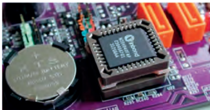
Εικ. 1.19. Μνήμη ROM στην μητρική πλακέτα ενός υπολογιστή.
