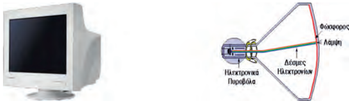
Εικ.1.29: Οθόνη καθοδικού σωλήνα CRT.
