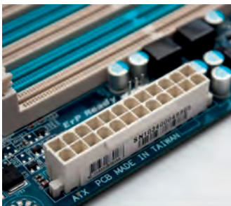
Εικ. 1.15: (α) Υποδοχή τροφοδοσία τύπου ATX 24pin, (β) σύνδεσμος (connector) ATX 24pin
