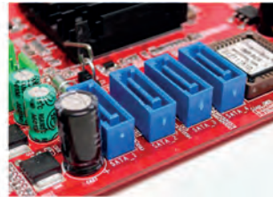
Εικ. 1.14. (α) Υποδοχές πρότυπου διασύνδεσης ATA/IDE, (β) Υποδοχές πρότυπου διασύνδεσης SATA .
