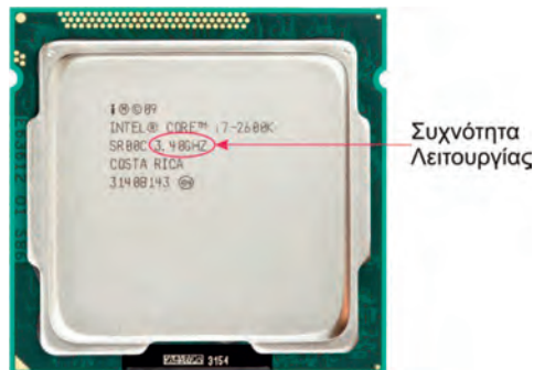
Εικ. 1.7. Επεξεργαστής της INTEL με αναγραφόμενη συχνότητα λειτουργίας τα 3.40 GHZ
