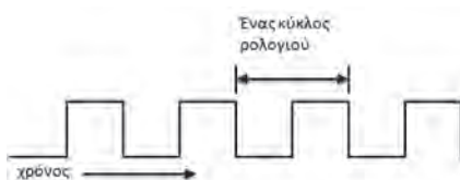
Σχ. 1.4. Περίοδος ή κύκλος του ρολογιού
