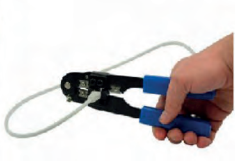
Εικ. 5.2. Βύσμα RJ45 (8P8C) και πρέσα για βύσματα RJ45.
