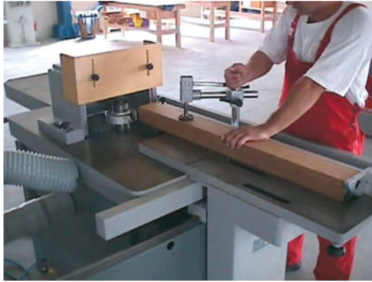
Εικ. 8.8 Εγκάρσια κατεργασία στη σβούρα.
