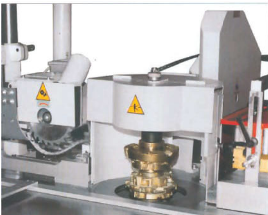
Εικ. 16.9 Πολλαπλή κεφαλή προφίλ και δισκοπρίονο.
