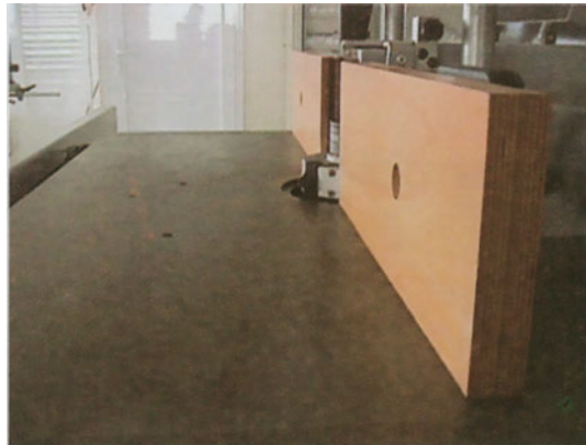
Εικ. 8.6 Ευθυγράμμιση και ρύθμιση των οδηγών.
