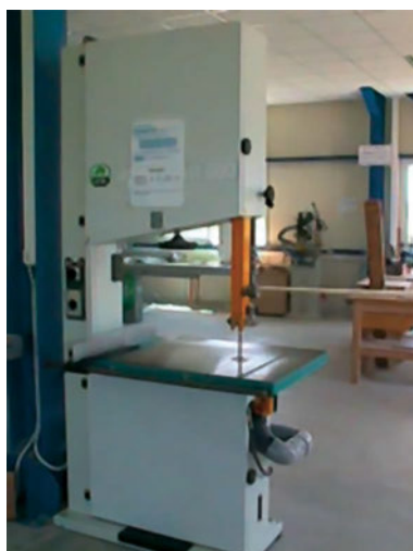
Εικ. 3.4 Ταινιοπρίονο επανάπρισης μικρού βάρους επιπλασιών, κτλ.
