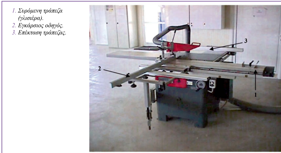
Εικ. 4.4 Δισκοπρίονο τεμαχισμού ξυλοπλακών.
