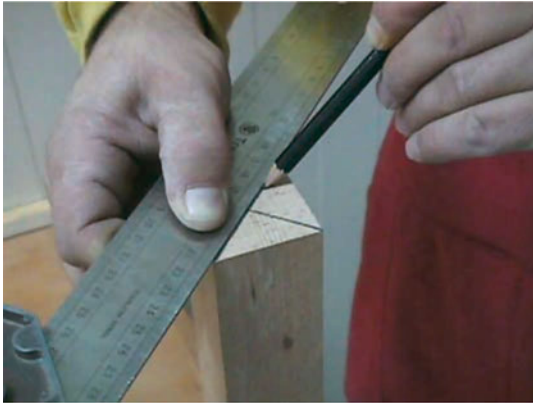
Εικ. 10.2 Εύρεση κέντρου εγκάρσιας επιφάνειας.
