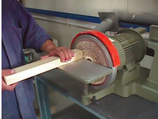
Εικ. 1.9 Λείανση ξύλου σε τριβείο δίσκου.
