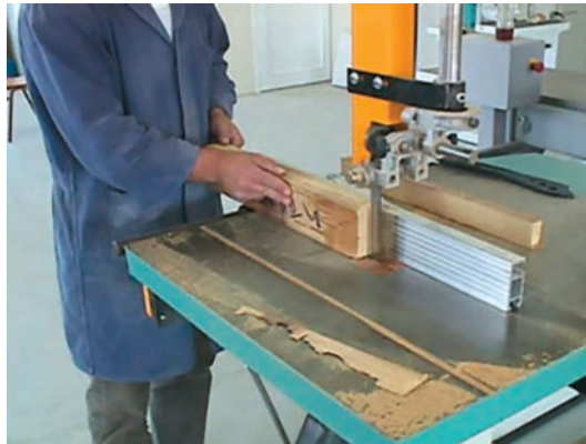
Εικ. 3.7 Στάση του χειριστή κατά την πρίση με ταινιοπρίονο
