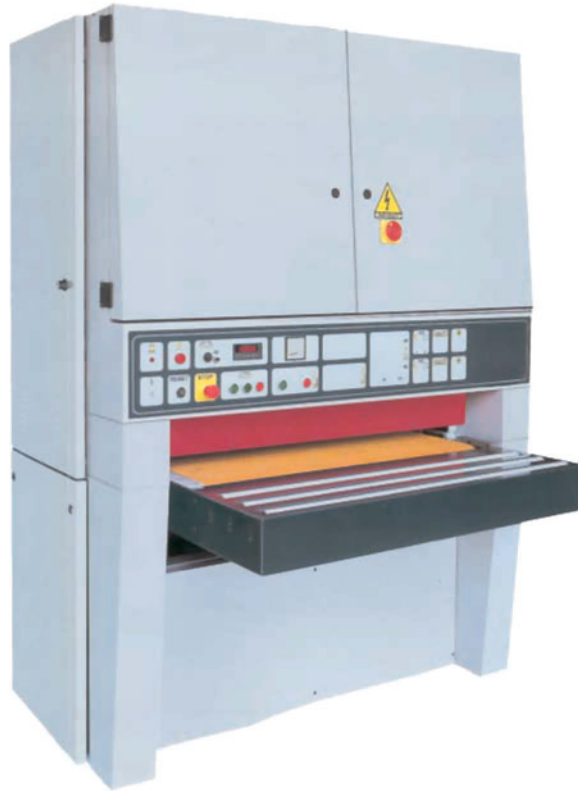
Εικ. 14.7 Τριβείο με πλατιά ταινία λείανσης.
