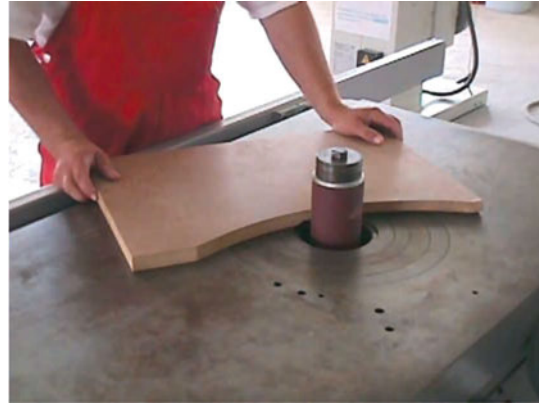
Εικ. 8.10 Λείανση καμπύλων επιφανειών με τριβείο κλίνδρον τοποθετημένο σε άξονα της σβούρας.
