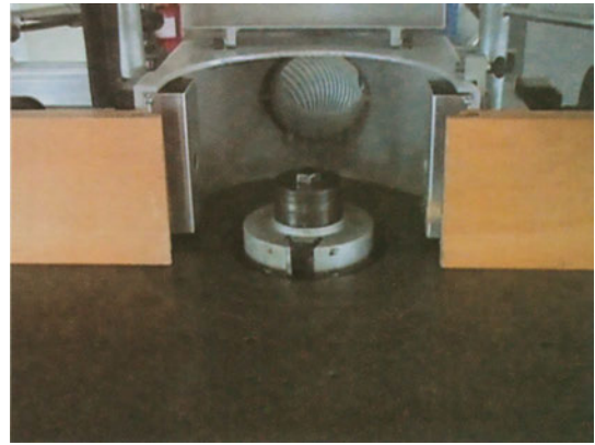
Εικ. 8.5 Κοπτικό που ένα τμήμα του προεξέχει πάνω από την τράπεζα εργασίας.
