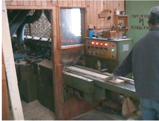
Εικ. 16.5 Τροφοδοσία ραμποτέζας με πιστή ξυλεία.
