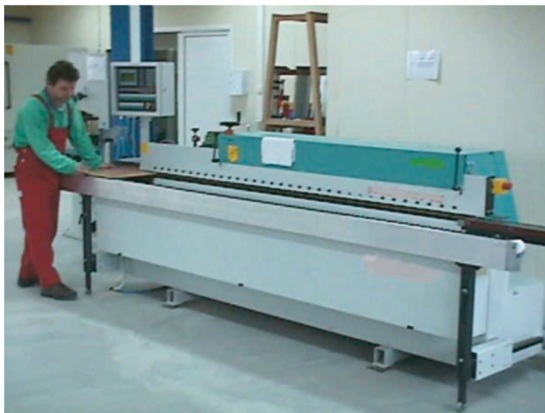
Εικ. 13.7 Τοποθέτηση ξυλοπλάκας στη συγκολλητική περιθωρίων.
