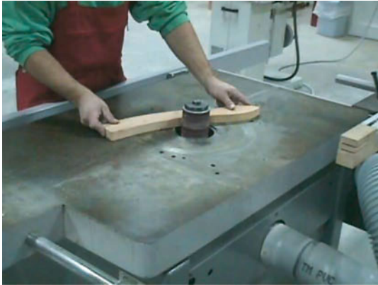
Εικ. 14.5 Λείανση ξύλου σε τριβείο κυλίνδρου.
