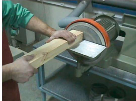
Εικ. 14.6 Λείανση ξύλου σε τριβείο δίσκου.
