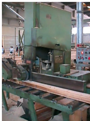
Εικ. 3.3 Ταινιοπρίονο επανάπρισης μεγάλου βάρους.
