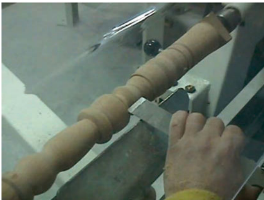
Εικ. 10.4 Δημιουργία μορφών με σκαρπέλο.
