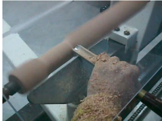
Εικ. 10.3 Τόνρευση ξύλου με καμπύλο σκαρπέλο.
