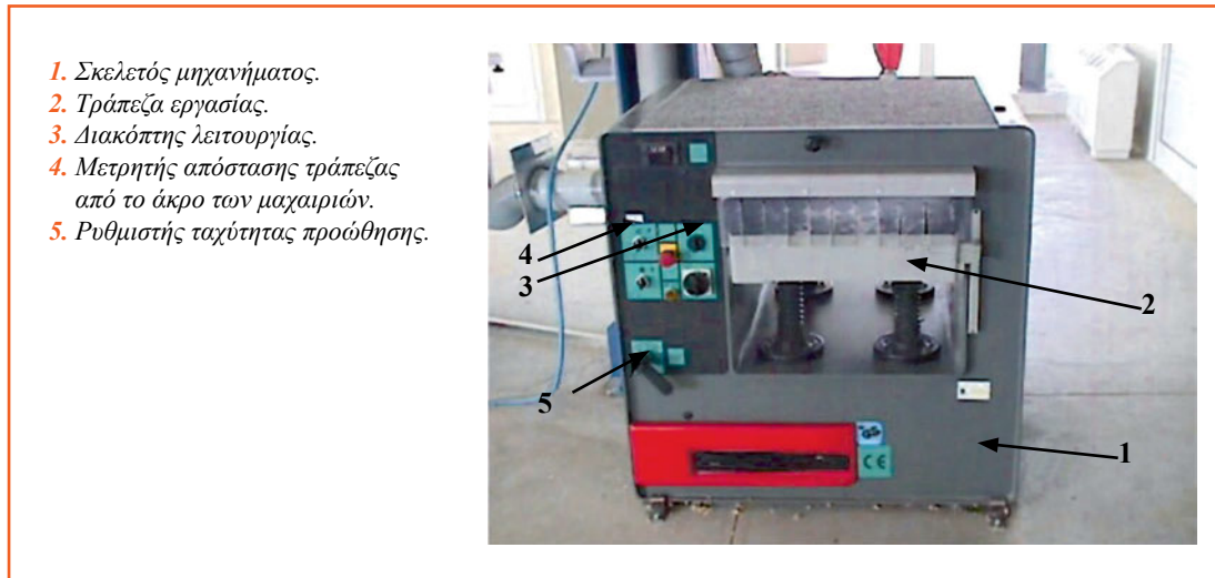
Εικ. 6.3 Τα κύρια μέρη του ξεchonδριστήρα.
