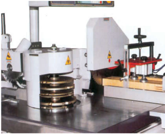
Εικ. 16.7 Πρίση εγκάρσιας επιφάνειας ξυλοτεμαχίου.
