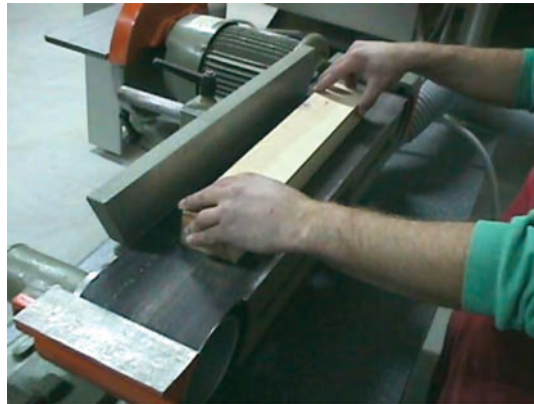
Εικ. 14.4 Λείανση ξύλου σε τριβείο ταινίας.
