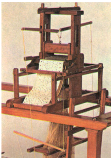
Εικόνα 9.6.: Αργαλειός για την παραγωγή περίπλοκων σχεδίων τύπου Jacquard (19ος αιώνας, Ιστορικό Μουσείο υφασμάτων, Λυών Γαλλίας).
