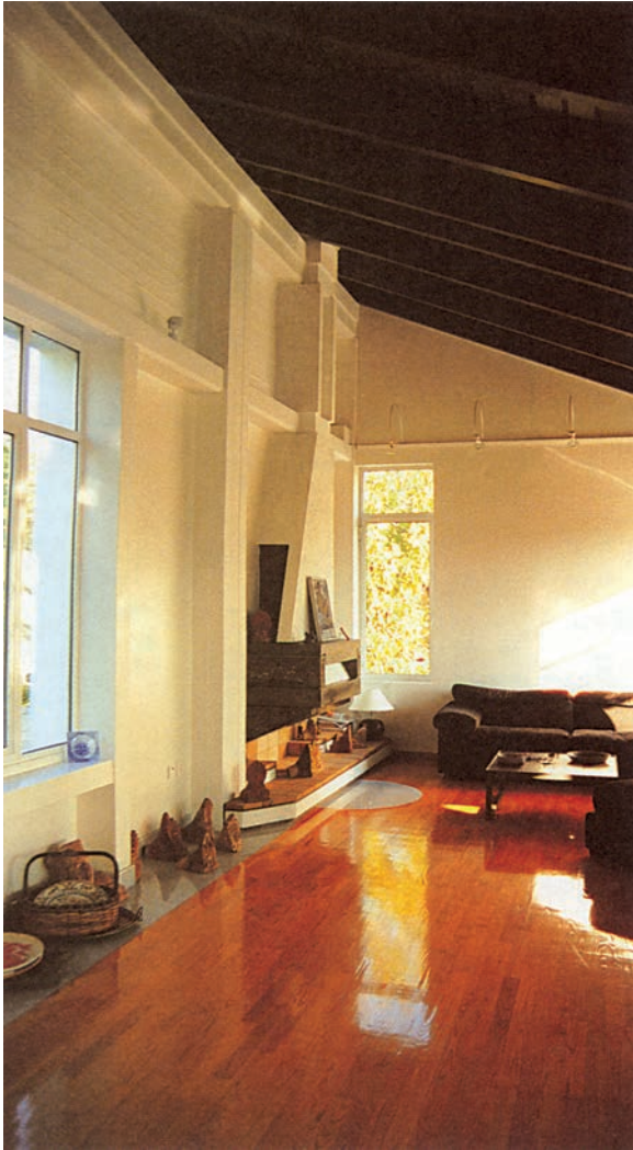
45. Διάχυτος φυσικός φωτισμός στο χώρο και αξιοποίηση της παθητικής ηλιακής ενέργειας, που εισβάλλει από τη νότια (δεξιά) πλευρά.
