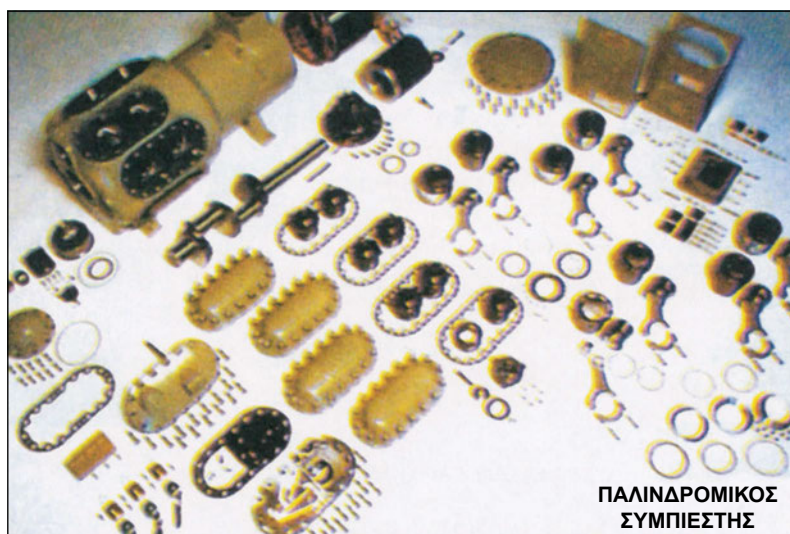
Εικόνα 2.50: Σύγκριση των κινούμενων μερών ενός κοχλιωτού και ενός παλινδρομικού συμπιεστή
