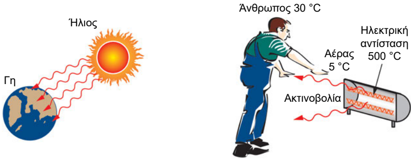
Εικόνα 1.30α: Η θερμική ενέργεια του ήλιου φθάνει στη γη, μεταδιδόμενη με ακτινοβολία μέσω του κενού
