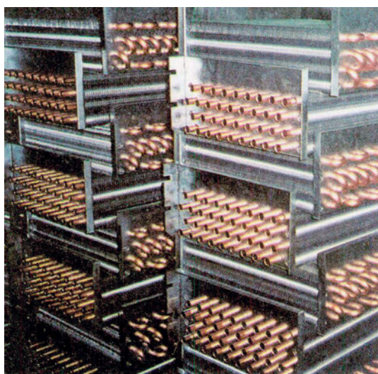
Σχήμα 7-16: Από το χώρο αποθήκευσης ημιέτοιμων στοιχείων (δεν έχουν ακόμη τοποθετηθεί οι συλλέκτες), σε ελληνικό εργοστάσιο κατασκευής κλιματιστικών μηχανημάτων.
