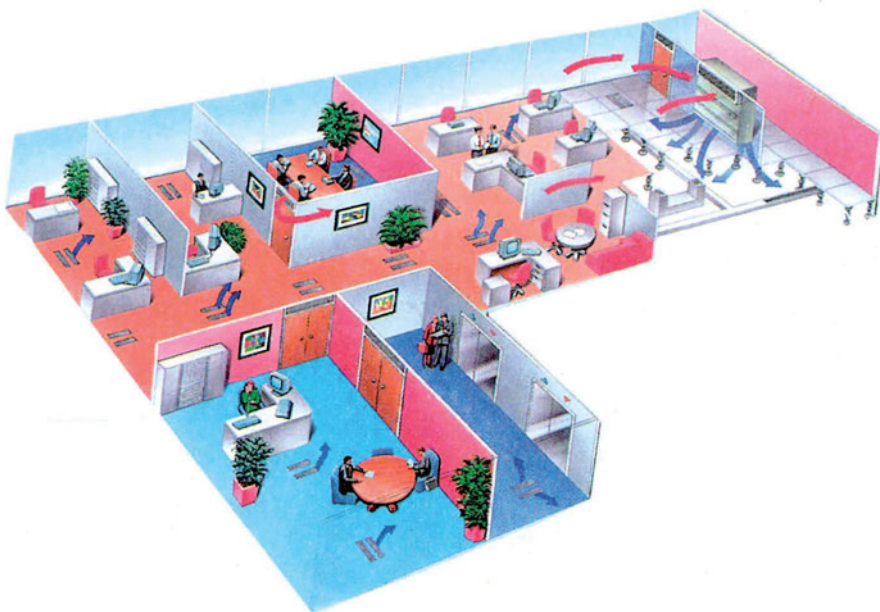
Σχήμα 8-67: Κλιματισμός συγκροτήματος γραφείων με μονάδα κλειστού κυκλώματος.
