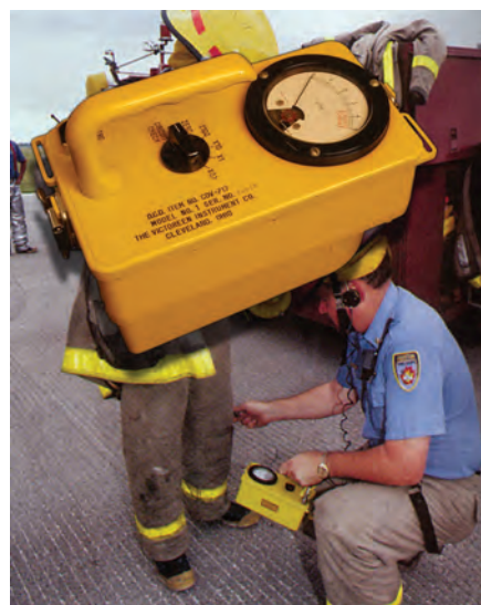
Εικόνα 10.17 Έλεγχος ραδιενεργού ακτινοβολίας σε εργαζόμενους σε πυρηνικό εργοστάσιο με ανιχνευτή Γκάιγκερ.
