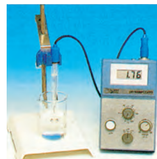
Μέτρηση του pH με τη βοήθεια πεχάμετρου
