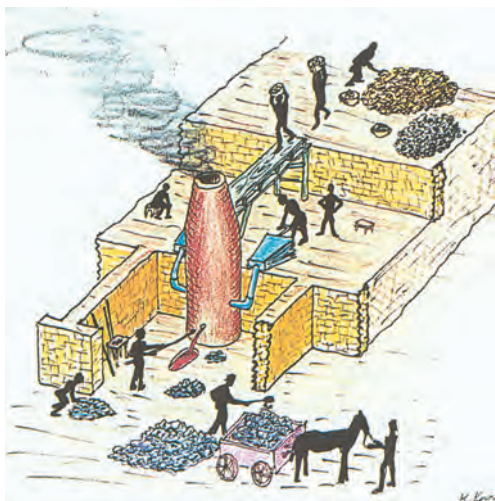
Κάμινος τήξης μεταλλεύματος. (Αναπαράσταση: Κ. Κονοφάγος.)
