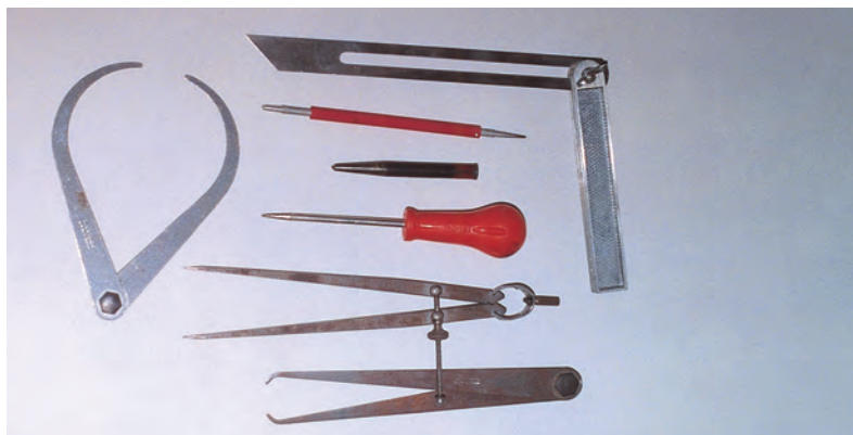
Εικόνα 4.27: Εργαλεία χάραξης μετάλλου.
