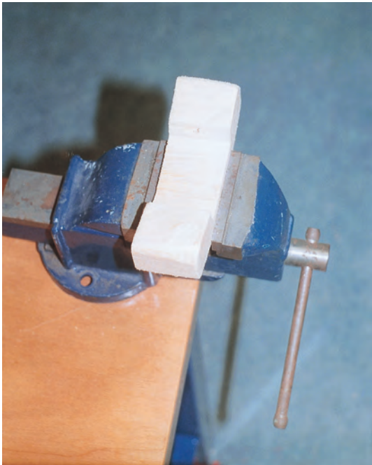
Εικόνα 4.18: Τα κομμάτια του ξύλου που κατεργάζομαστε θα πρέπει να στερεώνονται είτε σε μέγγενη είτε στον πάγκο εργασίας με τη βοήθεια σφιγκτήρων.
