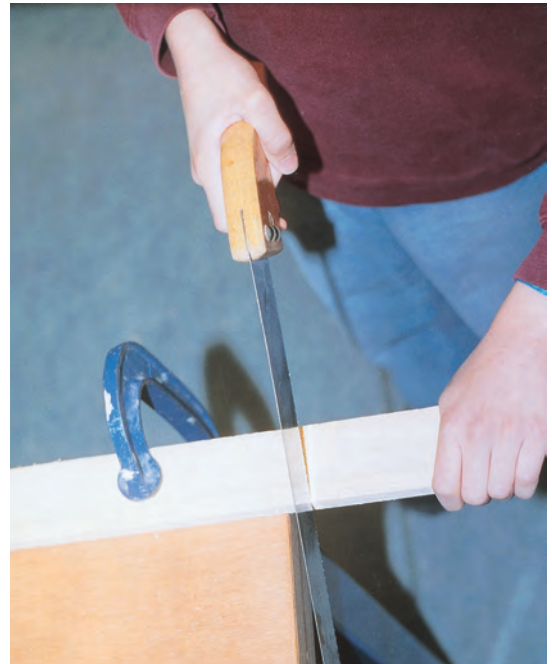
Εικόνα 4.18: Τα κομμάτια του ξύλου που κατεργάζομαστε θα πρέπει να στερεώνονται είτε σε μέγγενη είτε στον πάγκο εργασίας με τη βοήθεια σφιγκτήρων.
