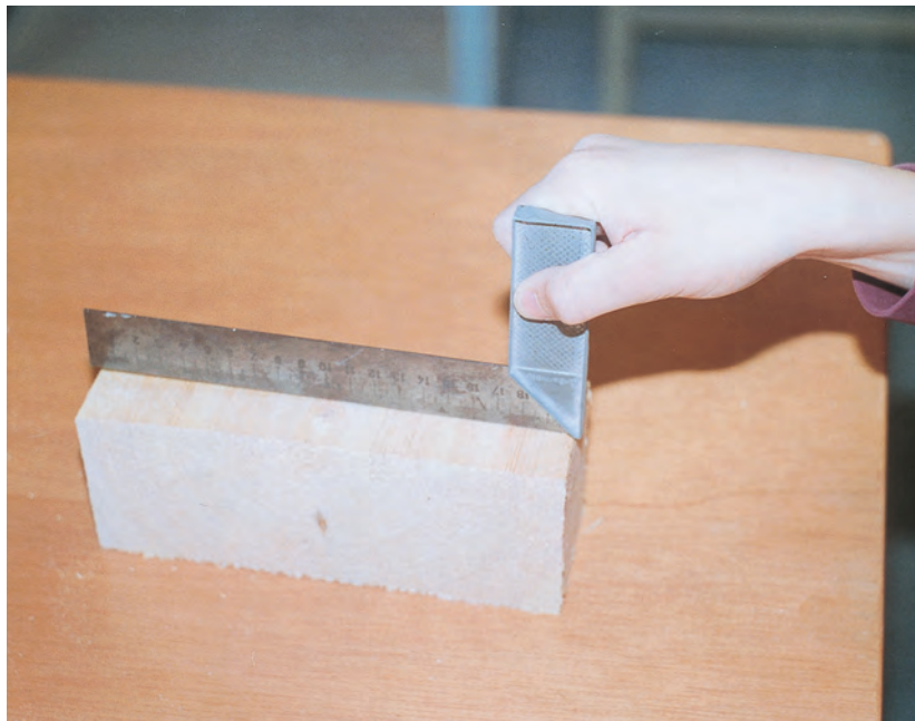
Εικόνα 4.10: Έλεγχος γωνιάσματος και επιπεδότητας.
