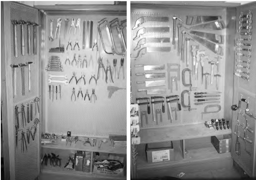
Εικόνα 8.4: Η τοποθέτηση των εργαλείων γίνεται σε ντουλάπες, όπου σημειώνεται το περιγράμματά τους.
