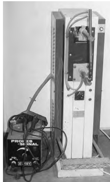
Εικόνα 9.8: Ηλεκτροπόντα και φορητή ηλεκτροσυγκόλληση.
