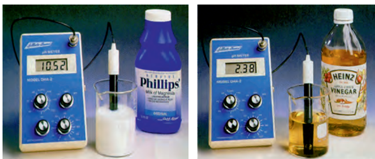
ΣΧΗΜΑ 5.9 Προσδιορισμός της τιμής pH με πεχάμετρο σε: α. γάλα της μαγνησίας - διάλυμα Mg(OH)_2 , β. ξύδι - διάλυμα CH_3COOH .
