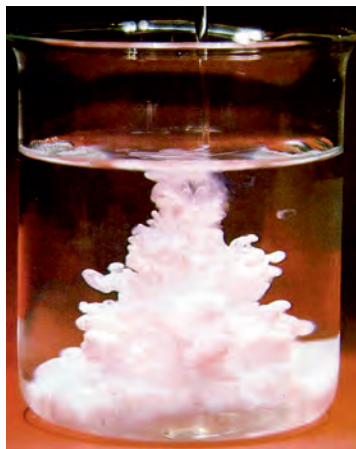
ΣΧΗΜΑ 5.21 α. Διαγραμματική απεικόνιση των συνθηκών κάτω από τις οποίες σχηματίζεται ιζημα AgCl β. σχηματισμός ιζήματος AgCl κατά την ανάμιξη διαλύματος AgNO_3 με διάλυμα NaCl .
