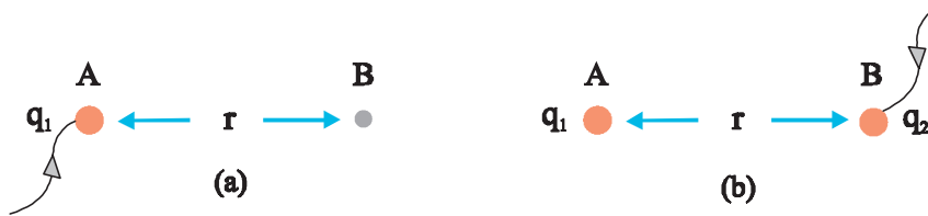
Σχ. 3.20 Αρχικά τοποθετούμε το q_1 στο σημείο A (a), στη συνέχεια το q_2 στο σημείο B (b).
