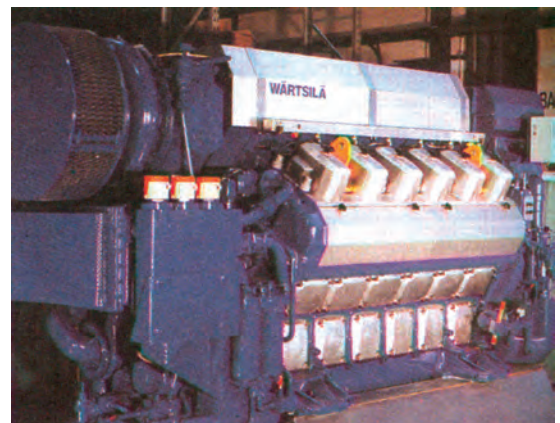
Εικ. 2.8 Φινλανδικός κινητήρας Diesel Wartsila 12 κύλινδροι σε διάταξη V.
