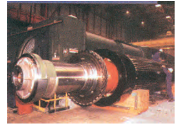
Εικ. 5.8 Γεννήτρια σε σταθμό παραγωγής ηλεκτρικής ενέργειας με πυρηνική ενέργεια.
