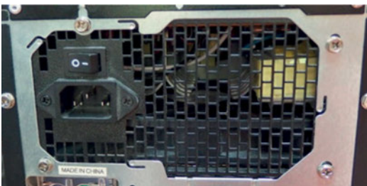
Εικόνα 24.Το πίσω μέρος ενός τροφοδοτικού ATX
