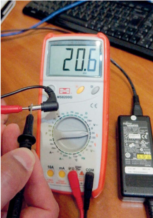
Εικόνα 196. Μέτρηση τροφοδοτικού με πολύμετρο
