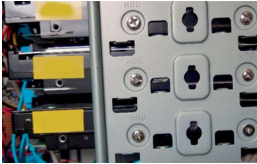
Εικόνα 31.Στήριξη μονάδων δίσκων στο πλαίσιο της θήκης
