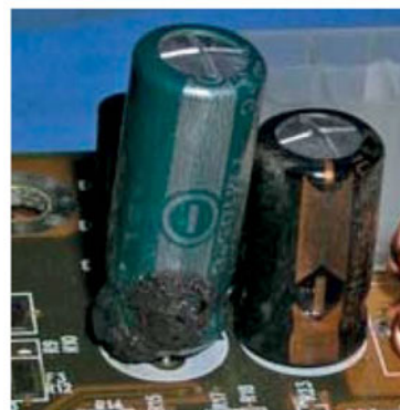
Εικόνα 263: Κατεστραμμένος πυκνωτής σε μητρική πλακέτα
