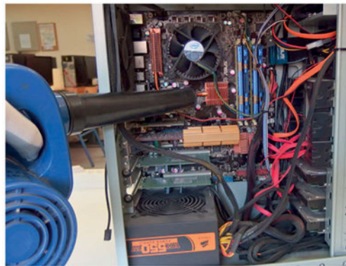
Εικόνα 68.Καθαρισμός με ηλεκτρικό φουσητήρα
