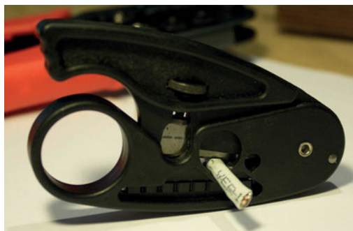
Εικόνα 5: Απογυμνωτής εξωτερικής μόνωσης καλωδίων UTP
