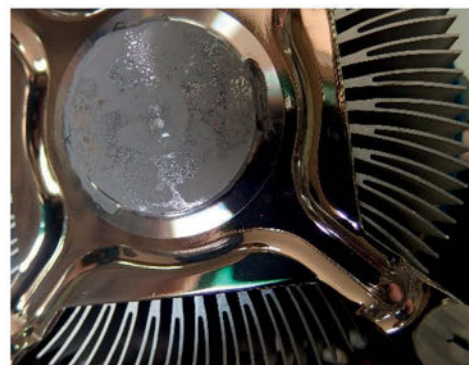
Εικόνα 65. Κατάλοιπα θερμοαγωγίμης κόλλας
