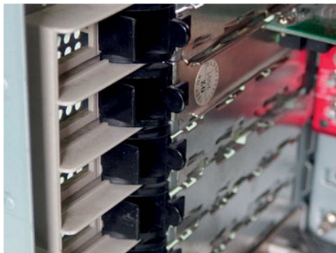
Εικόνα 34.Στερέωση καρτών επέκτασης χωρίς εργαλεία
