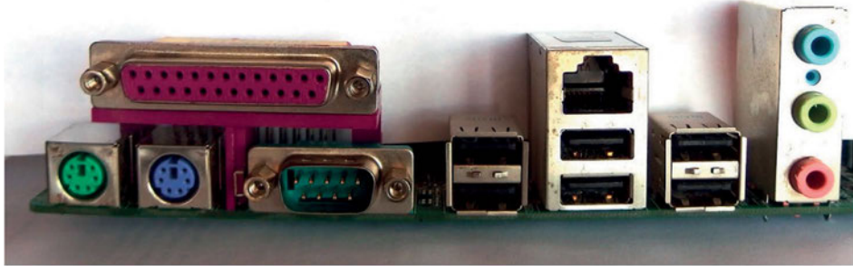
Εικόνα 90. Back I/O από παλαιότερη μητρική πλακέτα, παρατηρήστε την ύπαρξη της παράλληλης θύρας και την οξείδωση των μεταλλικών πλαισίων των θυρών.
