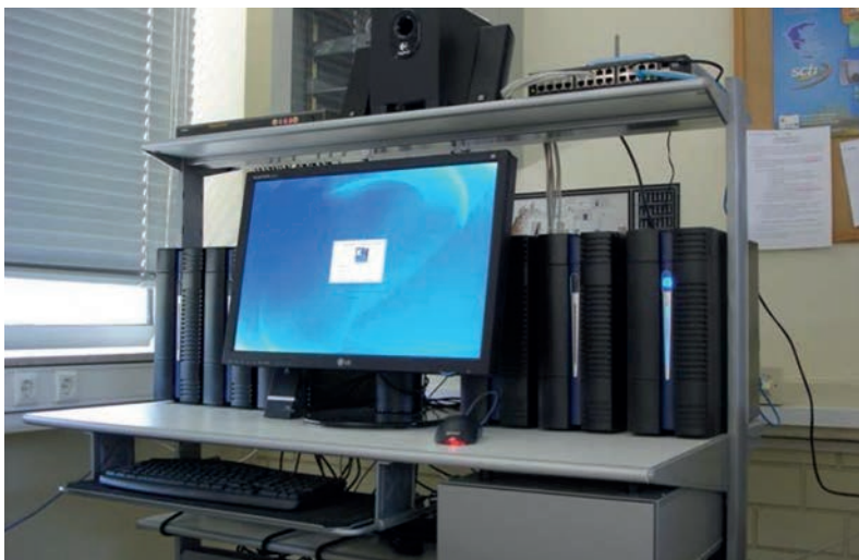
Εικόνα 4.2. Η συστοιχία υπολογιστών που έφτιαξαν οι μαθητές του 1ου ΕΠΑΛ Αργυρούπολης αποτελείται από 6 υπολογιστές με διτύρηνο επεξεργαστή και 2 GB RAM.
