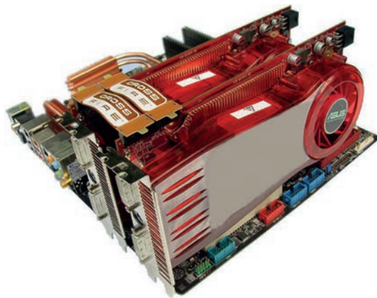
Εικόνα 1.2: Εγκατάσταση διπλών καρτών γραφικών τεχνολογίας Crossfire
