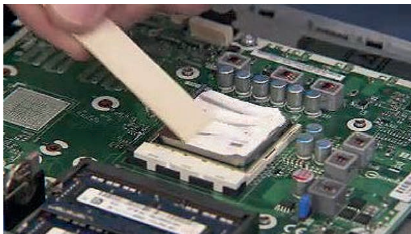
Εικόνα 2.7: Εφαρμογή θερμοαγώγιμης πάστας
