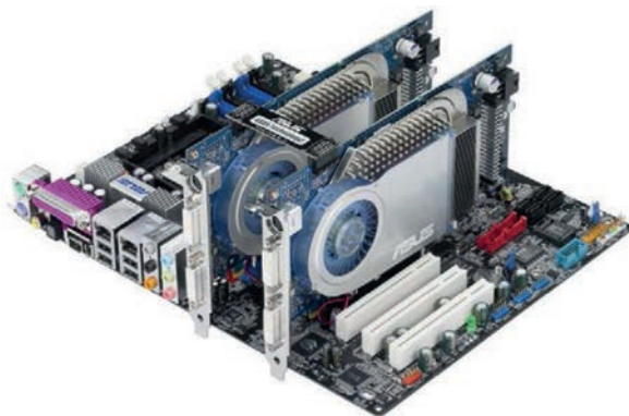
Εικόνα 1.3: Εγκατάσταση διπλών καρτών γραφικών τεχνολογίας SLI
