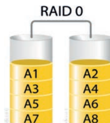
Εικόνα 3.1. Συστοιχία RAID 0 (striping).
