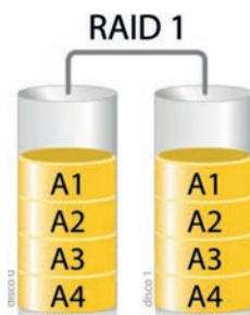
Εικόνα 3.2. Συστοιχία RAID 1 (mirroring).
