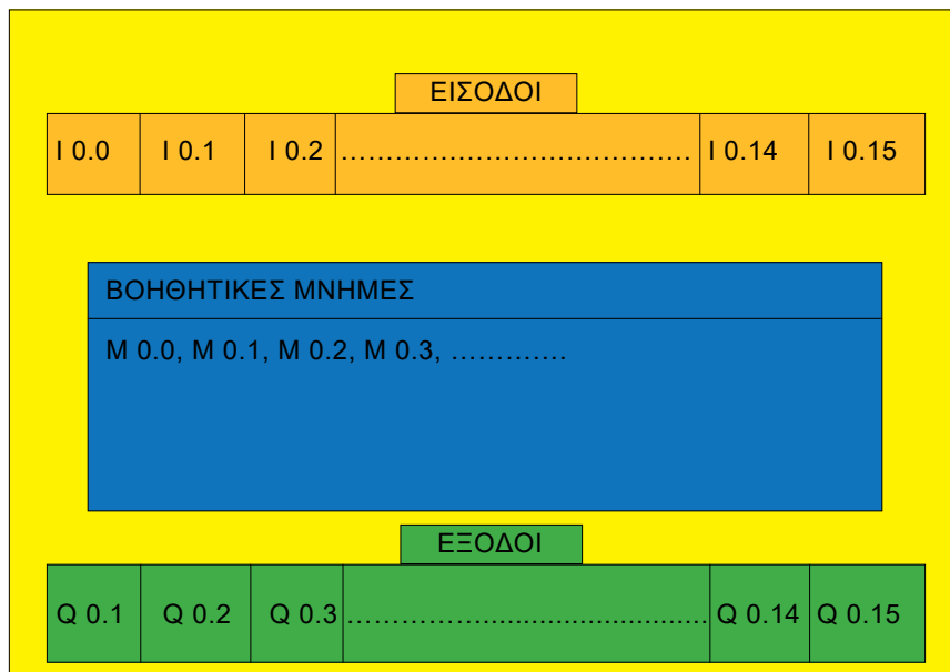
Σχήμα 16: Προγραμματιστικό μοντέλο του PLC που θα χρησιμοποιήσουμε στον προγραμματισμό.
