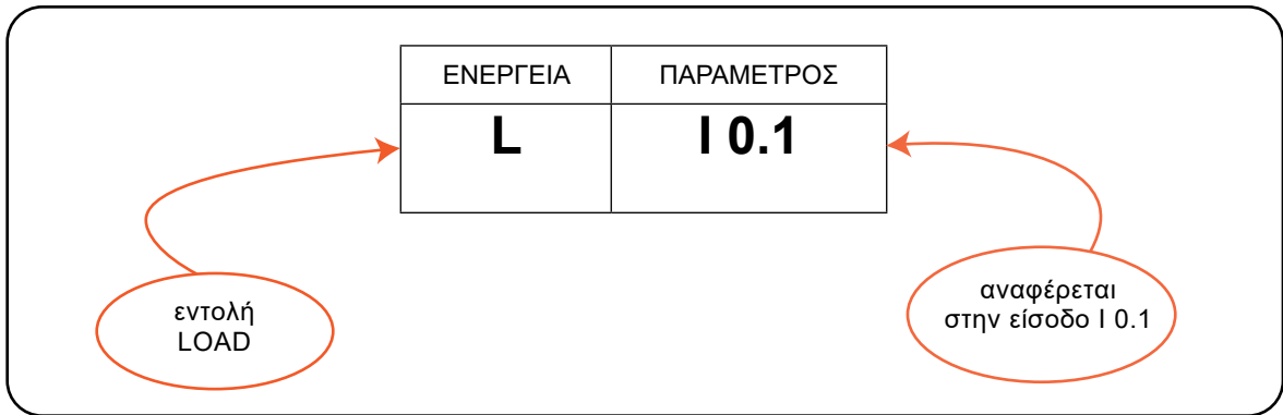
Σχήμα 18: Μορφή εντολής στη γλώσσα λίστα εντολών.
