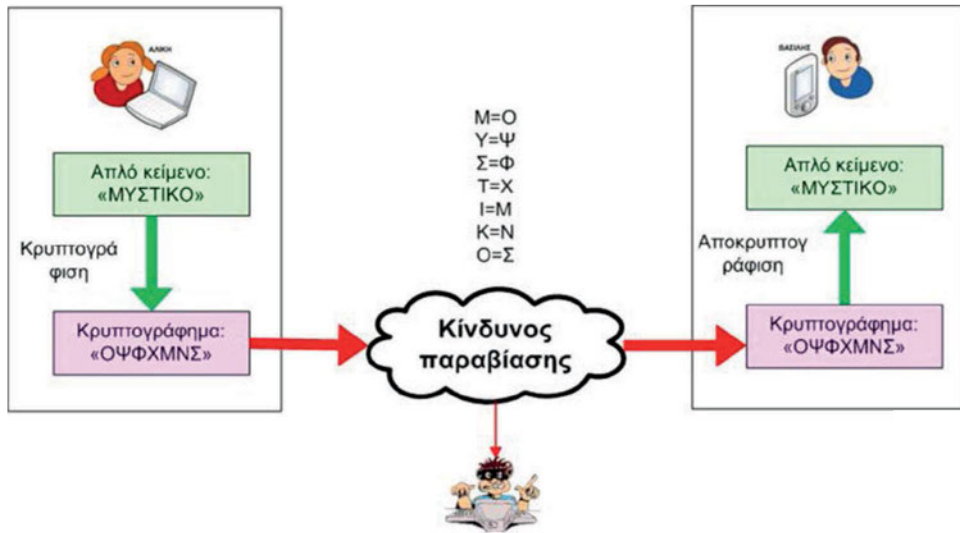
Εικόνα 8.2.2.α: Κρυπτογράφηση με Μυστικό κλειδί
