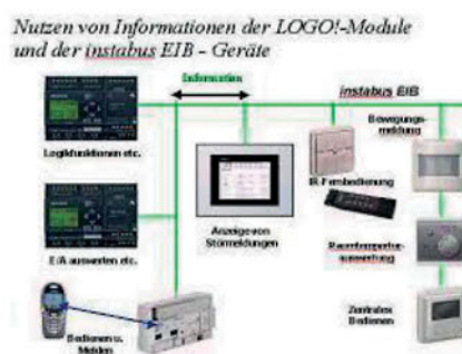
Εικόνα 44: Διάγραμμα διασύνδεσης συσκευών instabus
