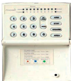
Εικόνα 5: Κεντρική μονάδα με ενδεικτικές λυχνίες (LED)
