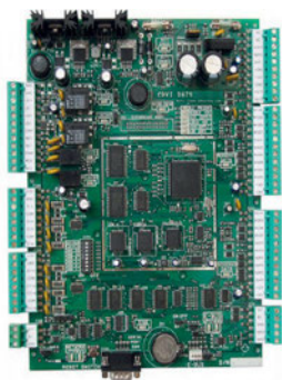
Εικόνα 30: Κεντρική μονάδα Access Control
