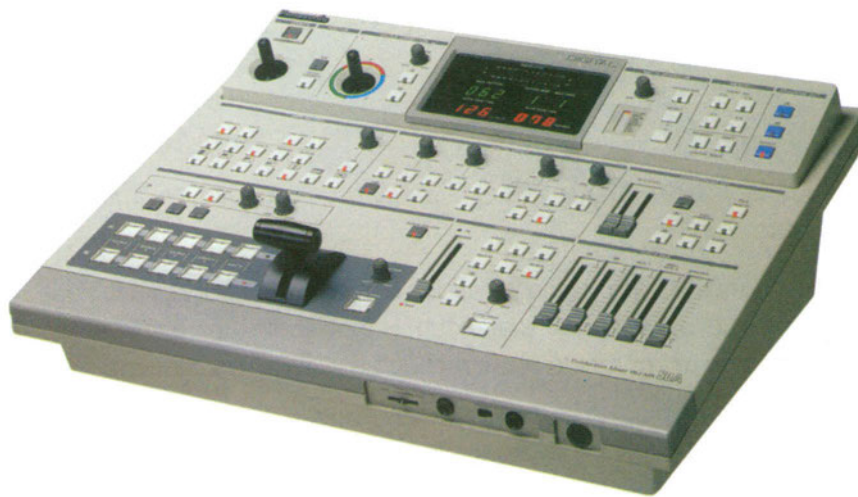
Σχήμα 5.14.ε Μεταγωγέας με γεννήτρια τεχνασμάτων
