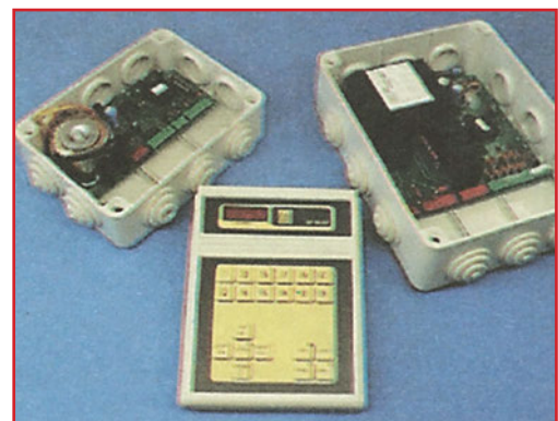
Σχήμα 6.3: Κεντρική Μονάδα Ελέγχου
