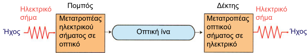
Σχήμα 3.13: Σύστημα μεταφοράς φωνής με οπτική ίνα.
