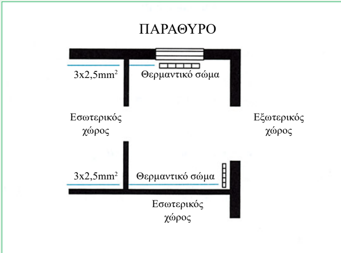
Σχήμα 2.3. Τοποθέτηση των θερμαντικών σωμάτων στην κάτοψη.
