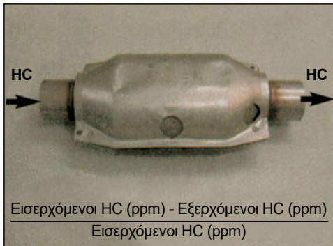
Σχήμα 14: Υπολογισμός του βαθμού απόδοσης ενός καταλύτη.
