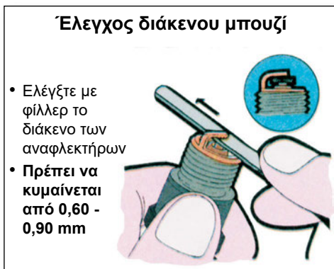
Σχήμα 11: Έλεγχος αναφλεκτήρων (μπουζί) με φύλλερ.
