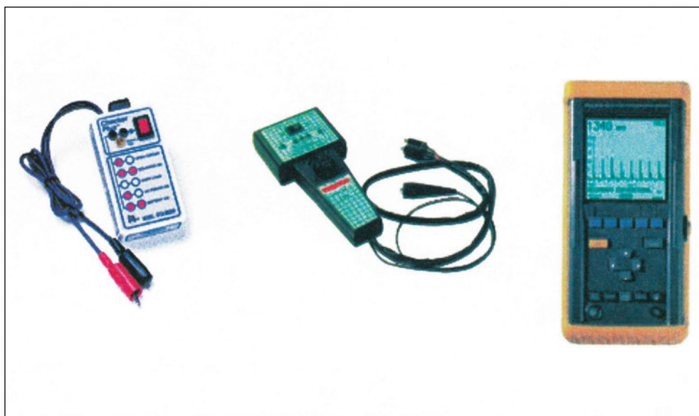
Σχήμα 5: Ειδικά όργανα ελέγχου ηλεκτρομαγνητικών ενεργοποιητών.
