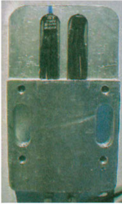
Σχήμα 2: Αισθητήρας στροφών φαινομένου Hall σε εκπαιδευτικό όχημα.
