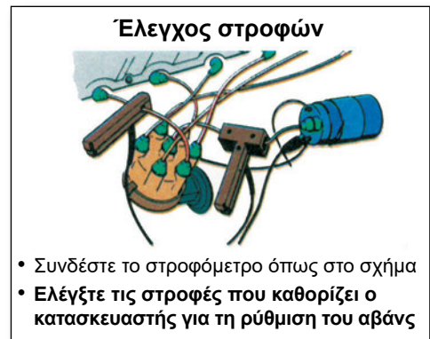
Σχήμα 12: Έλεγχος στροφών ρελαντί.
