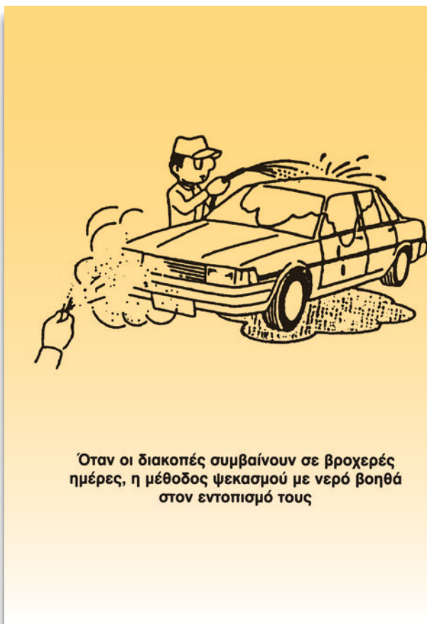
Σχήμα 3: Εντοπισμός προβλημάτων με τη μέθοδο του νερού.
