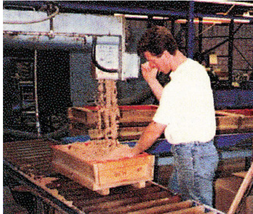
Σχήμα 10.6: Μηχανική τροφοδοσία άμμου σε καλούπι
