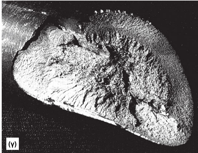
Σχήμα 3.5: (α) Μορφή επιφάνειας θραύσης από κόπωση (Α: θέση έναρξης ρωγμής, Β: επιφάνεια διάδοσης της ρωγμής λόγω της κόπωσης και Γ: επιφάνεια τελικής θραύσης). (β) Επιφάνεια θραύσης στροφαλοφόρου άξονα λόγω κόπωσης και (γ) επιφάνεια θραύσης χαλύβδινου άξονα, λόγω έντονης στρεπτικής κόπωσης.
