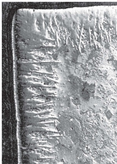
Σχήμα 18.2: Δομή απλού ανθρακούχου χάλυβα μετά από κατεργασία βορίωσης (μεγέθυνση X50)
