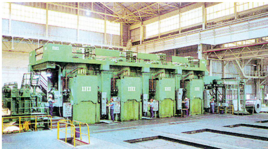
Σχήμα 13.13: Τετραπλό έλαστρο ψυχρής έλασης (Hellenic Steel)
