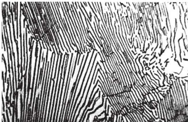
Σχήμα 4.4: Μορφή φυλλοειδούς ευτηκτικού (μεγέθυνση X2000)
