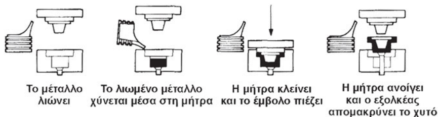
Σχήμα 10.15: Χύτευση σφυρηλάτησης
