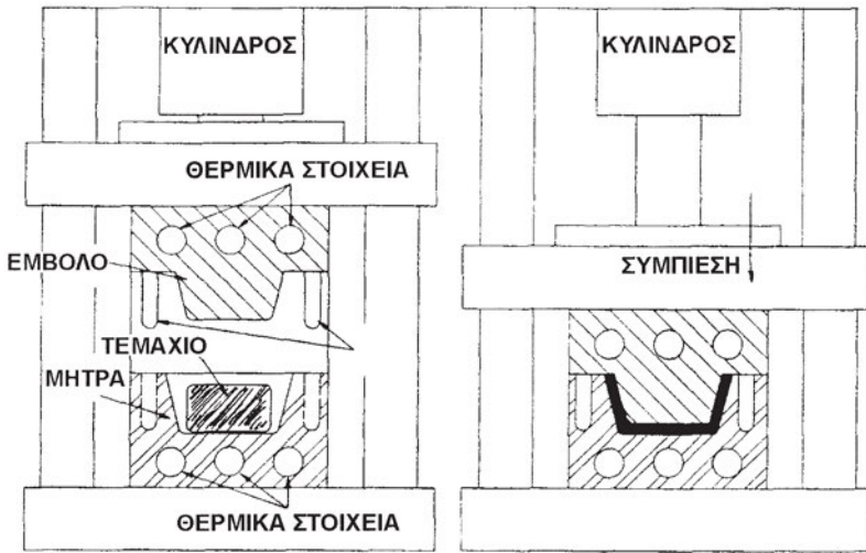
Σχήμα 15.11: Χύτευση με συμπίεση
