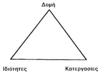
Σχήμα 1.2: Το "λειτουργικό τρίγωνο" της αλληλεπίδρασης δομής – ιδιοτήτων – κατεργασιών των υλικών
