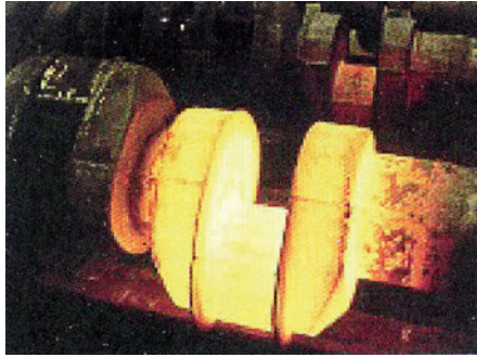
Σχήμα 13.10: Σφυρηλάτηση στροφαλοφόρου άξονα
