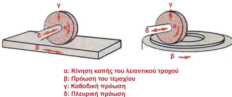
Σχήμα 6.20: Περιφερειακή λείανση με διαμήκη τράπεζα και με κυκλική τράπεζα.
