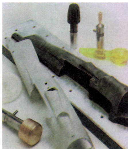
Σχήμα 9.14: Καλούπια έλασης και πρέσας που έχουν κατεργαστεί με κοπή σύρματος-ηλεκτροδίου.
