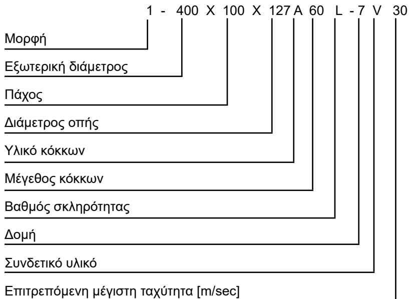
Σχήμα 6.6: Κωδική ονομασία λειαντικών τροχών.
