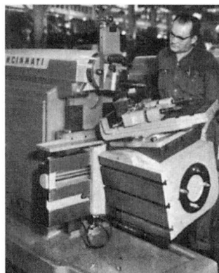
Σχήμα 7.5: Δυνατότητα περιστροφής του τεμαχίου σε τρεις άξονες για την κατεργασία σύνθετων γωνιών σε μια βραχεία πλάνη γενικής χρήσης (Universal).
