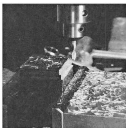
Φρεζάρισμα περιφέρειας κομματιού με κονδύλι
