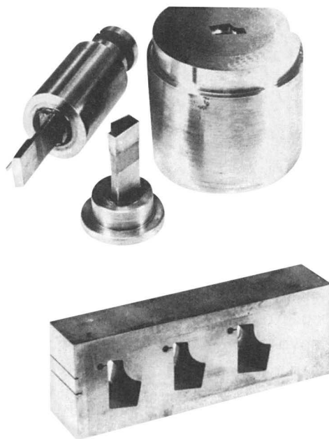
Σχήμα 9.9: Καλούπια για εργαλεία κατεργασίας ξύλου ως προϊόντα ηλεκτροδιάβρωσης και τα αντίστοιχα εργαλεία-ηλεκτρόδια.
