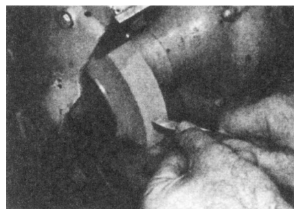
Σχήμα 4.32: Εκχόνδριση της δευτερεύουσας επιφάνειας ελευθερίας
