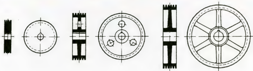
Εικ. 10.2.6 Τύποι τροχαλιών ιμαντοκίνησης. Ολόσωμη, δίσκος με τρύπες, ακτινωτή
