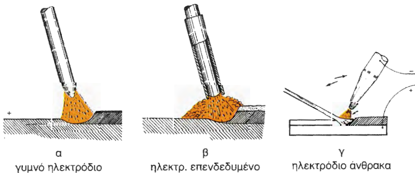
Εικ. 7.4β Συγκόλληση με ηλεκτρικό τόξο
