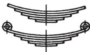
Εικ 7.6δ Ελατήρια πολλαπλών ελασμάτων
