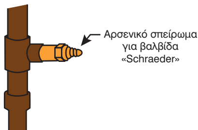
Σχήμα 21.7 Τοποθέτηση προσαρτήματος με βαλβίδα Schrader για μελλοντικές συντηρήσεις του συστήματος
