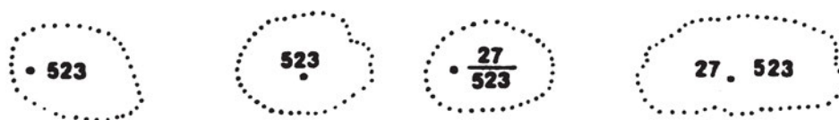
Σχήμα 42. Τρόποι γραφής υψομετρικών σημείων.
