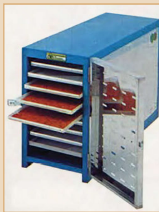
Εικόνα 4.15 Συσκευή ξήρανσης γύρης.
