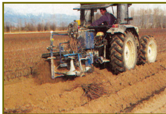
Εικ. 4.14 Μηχανική εκρίζωση των ριζοβοληθέντων μοσχευμάτων αμπέλου στο φυτώριο
