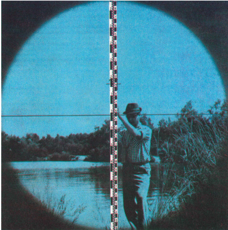
Εικ. 25 Η εικόνα που έχουμε όταν σκοπεύουμε τη σταδία με το χωροβάτη. Το οριζόντιο νήμα του σταυρονήματος τέμνει νοητά τη σταδία στην ένδειξη που πρέπει να διαβάσουμε.
