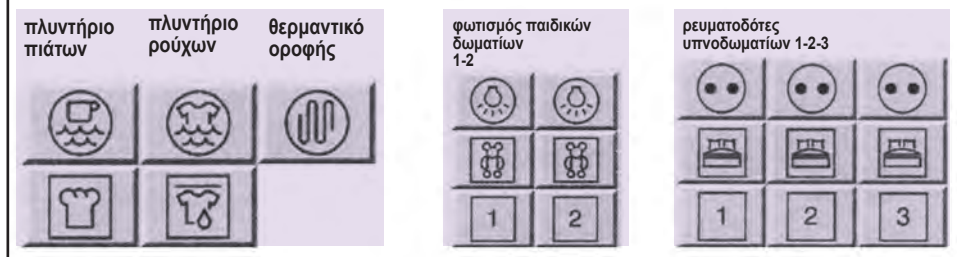
Εικόνα 7.4α: Παραδείγματα συστήματος σήμανσης των κυκλωμάτων
