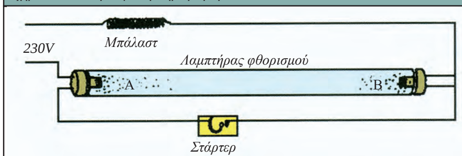
Σχήμα 8.5α: Συνδεσμολογία λαμπτήρα φθορισμού
