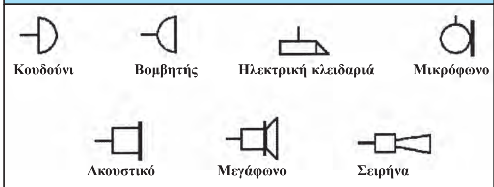
Σχήμα 10.1α: Σύμβολα κατά DIN
