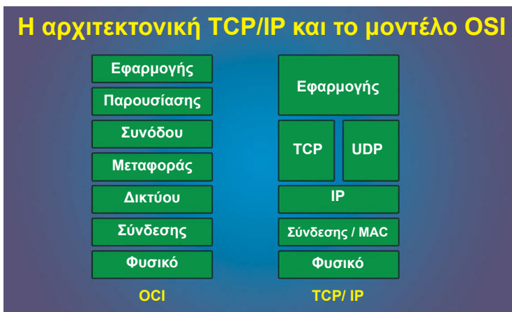
Σχήμα 9.1.2 OSI και TCP/IP
