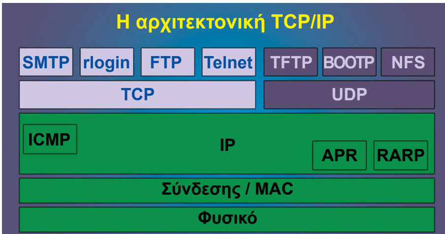
Σχήμα 9.1.3 Η δομή της TCP/IP αρχιτεκτονικής
