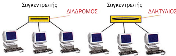
Σχήμα 5.2.10 Τοπολογίες τοπικών δικτύων και καλωδιώσεις
