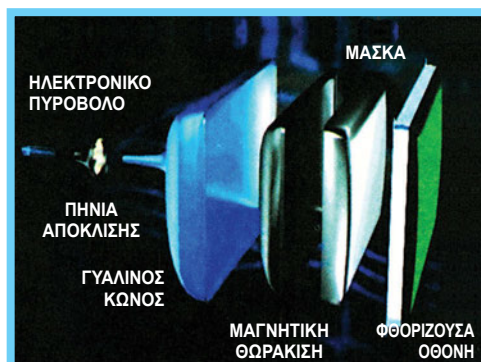
Σχήμα 6.3.5 Τα μέρη του σύγχρονου καθοδικού σωλήνα. Η εκτροπή της ηλεκτρονικής δέσμης γίνεται με μαγνητικό πεδίο από τα πηνία απόκλισης που βρίσκονται εξωτερικά αμέσως μετά το ηλεκτρονικό πυροβόλο.
