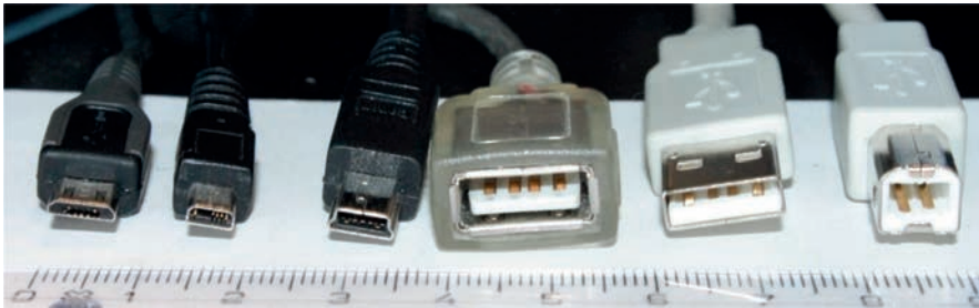
Εικ. 1.18. Διάφοροι τύποι βυσμάτων USB.
