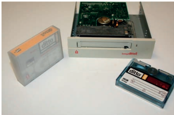
Εικ. 6.1. Σύστημα λήψης αντιγράφων ασφαλείας σε μαγνητικές κασέτες
