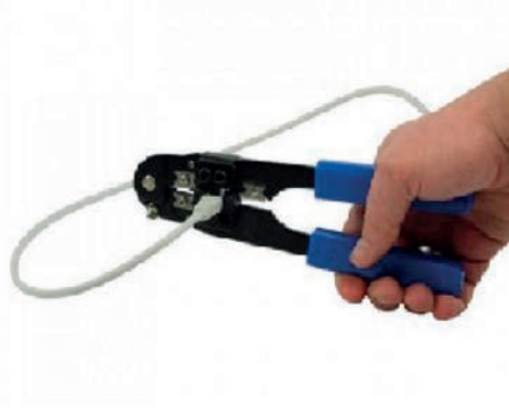
Εικ. 5.2. Βύσμα RJ45 (8P8C) και πρέσα για βύσματα RJ45.
