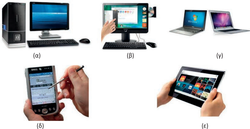
Εικ. 1.4. (α) υπολογιστής γραφείου, (β) υπολογιστής γραφείου με ενσωματωμένη την ΚΜ στην οθόνη (All in One PC, (γ) φορητός υπολογιστής, (δ) παλάμη - rda και (ε) tablet.
