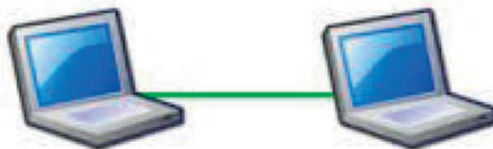
Σχήμα 5.14. Σύνδεση σταθμών με εξειδικευμένη σύνδεση (Ad Hoc).
