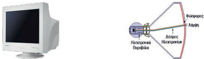
Εικ.1.29: Οθόνη καθοδικού σωλήνα CRT.
