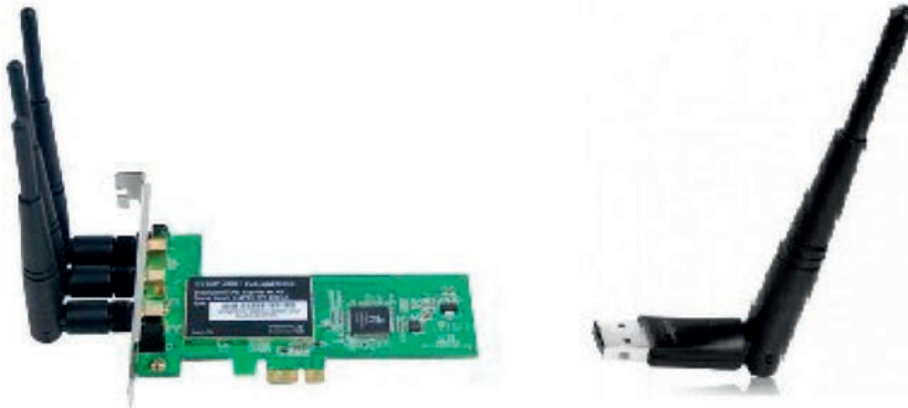
Εικ. 5.18 Ασύρματες Κάρτες δικτύου.
