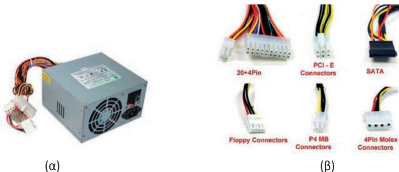
Εικ.1.25 : (α) Τροφοδοτικό τύπου ATX, (β) Διάφοροι τύποι ακροδεκτών (connectors) τροφοδοσίας.
