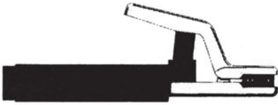
Σχήμα 8.4.2α: Λαβίδα συγκρατήσεως του ηλεκτροδίου (αρνητικός πόλος)
