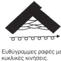
Σχήμα 8.4.8β: Κινήσεις του ηλεκτροδίου για τη δημιουργία συγκολλητικής ραφής στις διάφορες θέσεις συγκόλλησης
