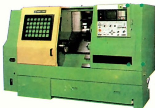
Σχήμα 1.3β Σύγχρονος προγραμματιζόμενος τόννος (CNC) και η εργαλειοφόρα κεφαλή του
