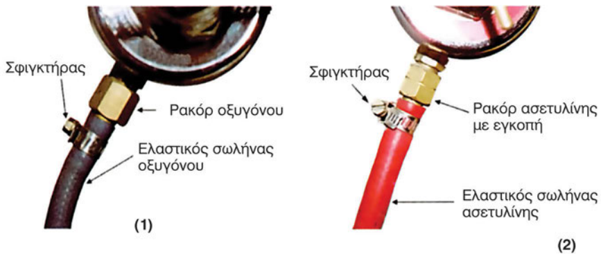
Σχήμα 8.3.5α: 1) Σύνδεση ελαστικού σωλήνα οξυγόνου με τη βοήθεια ρακόρ στο μανομετρικό εκτονωτή. 2) Σύνδεση ελαστικού σωλήνα ασετυλίνης με τη βοήθεια ρακόρ με εγκοπή στο μανομετρικό εκτονωτή.
